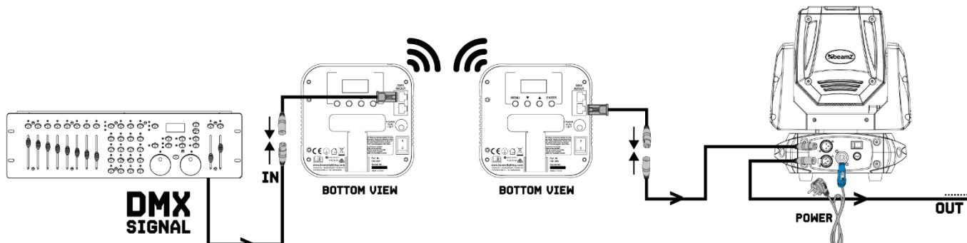
**UWAGA!** Na ostatnim urządzeniu musisz mieć linię DMX z rezystorem końcowym. Weź złącze XLR i przyłącz rezystor 120 Ohm między sygnałem (-) a sygnałem (+) i podłącz go do wyjścia DMX ostatniego urządzenia w linii.
