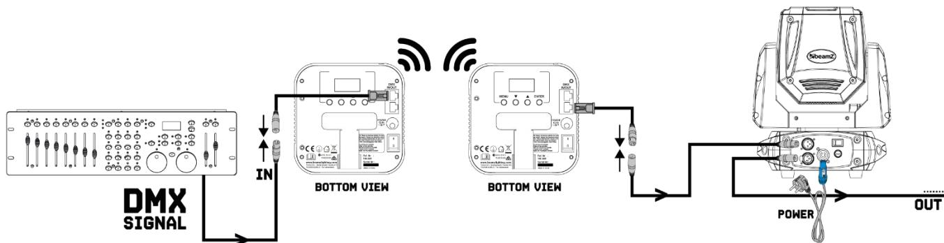
**ATTENTION!** sur le dernier appareil, vous devez terminer la ligne DMX avec une résistance. Prenez un connecteur XLR et soudez une résistance de 120 ohms entre le signal (-) et le signal (+) et connectez-la à la sortie DMX du dernier appareil sur la ligne.
