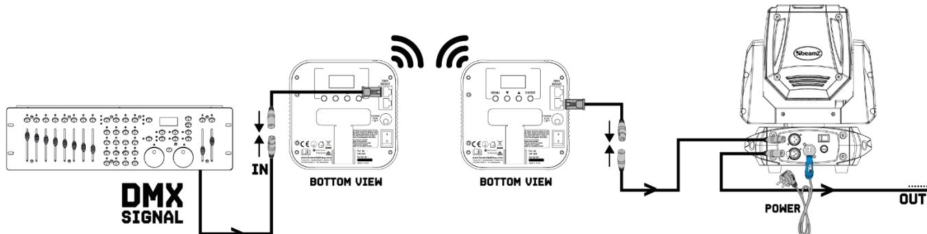
**ATENCIÓN!** En el último aparato, debe cerrar la línea DMX con una resistencia de terminación. Tome un conector XLR y suelde una resistencia de 120 Ohm entre la señal (-) y la señal (+) y conéctela a la salida DMX del último dispositivo en la línea.
